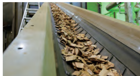
バイオマス発電機で発生した熱源をうまく利用して、木質チップの乾燥する熱源に変えている。
