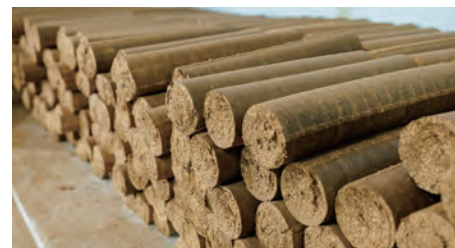
木質チップから発生する『おがくず』から木質ペレットやブリケットという『成形された薪』を製造。
